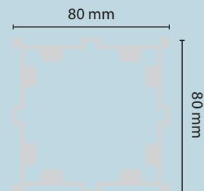
hms easy stretch bietet verschiedene Profile in einem kombinierbaren System, mit Profilstäben von 40, 80, 120 und 160 mm für unterschiedliche Einsatzzwecke und Möglichkeiten. Um möglichst große Stabilität zu erhalten, werden größere Profile eingesetzt. Ebitas moditis reibus re num corum veri quiae simporitium quas
