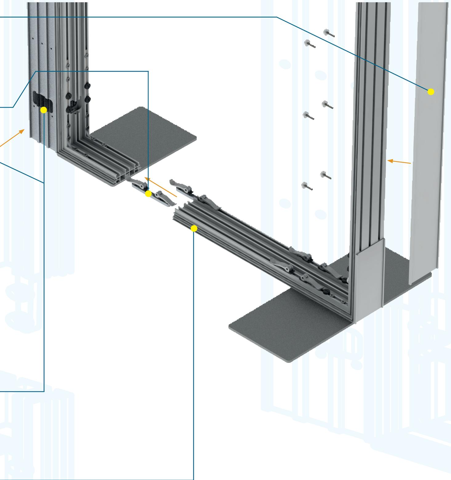
hms easy stretch bietet verschiedene Profile in einem kombinierten System, mit Profilstärken von 40, 80, 120 und 160 mm für unterschiedliche Einsatzzwecke und Möglichkeiten. Um möglichst große Stabilität zu erhalten werden breitere Profile eingesetzt.
